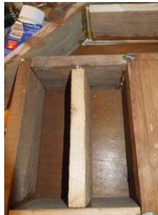
Fürs Dach benötigt man die zwei noch übrigen Bretter mit den Maßen 40cm\*10cm. Diese werden im rechten Winkel zusammengenagelt und anschließend auf den Grundstock gesetzt und dort befestigt.
